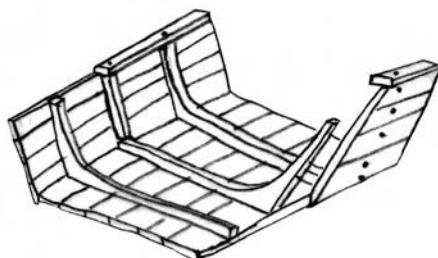
9. kép A dereglye axonometrikus rekonstrukciós rajza Fig. 9. Axonometric reconstruction drawing of the light boat
